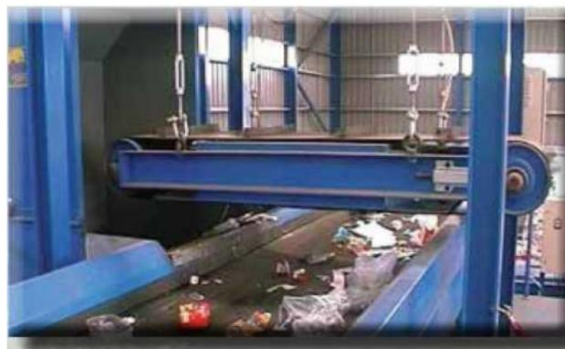
Ленточный сепаратор металлов
