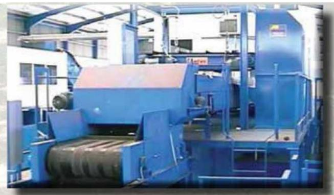
Сепаратор цветных металлов вихревым потоком
