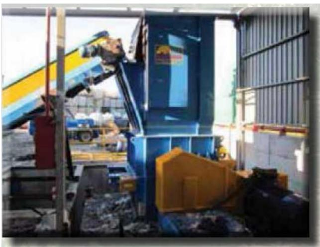
ВТОРИЧНЫЕ ШРЕДЕРЫ: УМЕНЬШАЮТ РАЗМЕР ОТХОДОВ ДО ИХ КОНЕЧНОЙ ГРАНУЛОМЕТРИИ - 30 мм.
