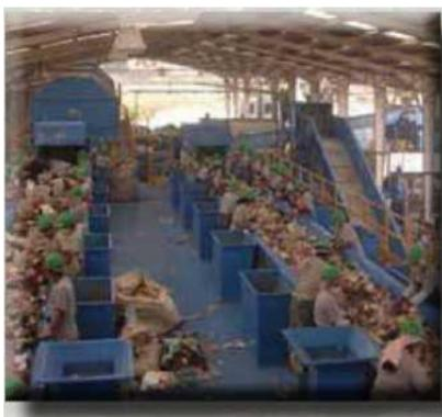
конвейер по сортировке полезных
