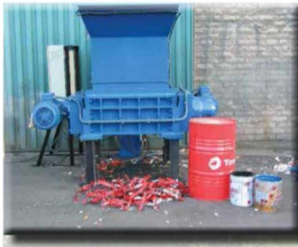
Дробилка с толкателем для металлических бочек, пластиковых бутылок и т.д.
